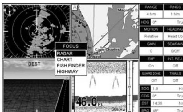
Рисунок 17.2.4.2. Комбинированная Страница с клавишей [**Focus**] на экране **CPF300i**
