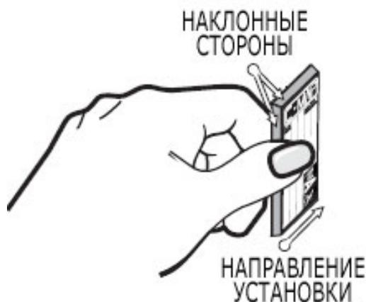
Рисунок 5.0 Установка C-CARD
