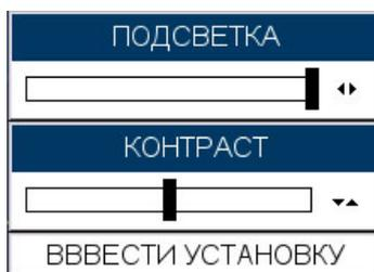
Рисунок 3.1.3. Настройка контрастности и яркости дисплея
