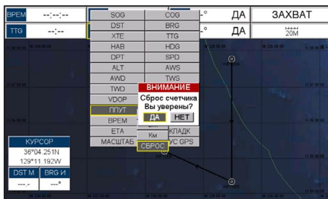
Рисунок 10.1.0 Сброс счетчика
