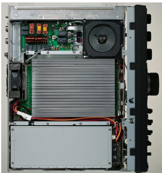
Вид сверху со снятой крышкой. Видны фильтры, УМ, сетевой блок питания
